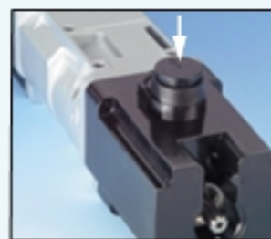
Krok 3: Nasajte predĺženie „krátke“ (u HTM najprv predĺženie „dlhé“ bez krytky)
